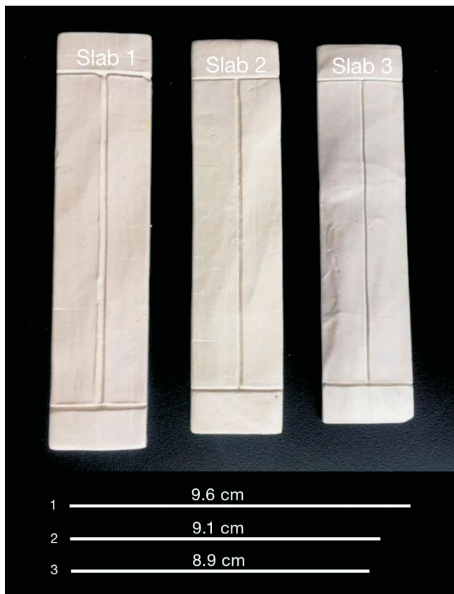
Fig. 2: Slab 1:1 150 °C, Slab 2:1 250 °C & Slab 3:1 300 °C respectively.
